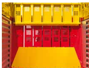
Sullontakanavan kansi rehuvaunu käyttöä varten
